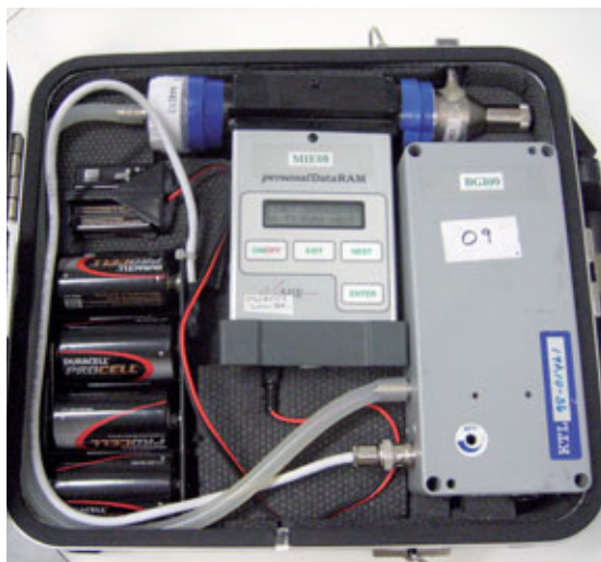
Kuva 5. Ihmisen altistumisen mittauksessa käytetty mittaussalkku Kansanterveyslaitoksen ULTRA-tutkimuksessa Helsingissä. Tutkimukseen osallistuneet henkilöt kuljettivat salkkua mukanaan.
