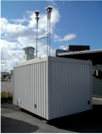
Kuva 7. Kansanterveyslaitoksen ja Ilmatieteen laitoksen yhteishankkeissa käytetty siirrettävä mittausasema ja suuritehoinen monivaiheimpaktori. Monivaiheimpaktori kerää mittausaseman katolla olevan ison PM_{10} -esierottimen lävitse yhdyskuntailman hiukkasia 3-4 kokoluokkaan. Ilman virtausnopeus on 850 litraa minuutissa. Oikealla on avattuna kolmivaiheinen impaktori-versio. Se kerää karkeat hengitettävät hiukkaset ( PM_{10-2.5} ) ja pienhiukkaset ( PM_{2.5-0.2} ) punertavalle polyuretaanivaahdosta valmistetulle liuskalle. Ultrapienet hiukkaset ( PM_{0.2} ) kerätään alimman tason lasikuitusuodattimelle, kuvassa äärimmäisenä vasemmalla.
