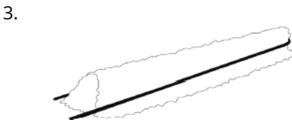
Der filter wird über das tränergitter gezogen und mit einer drahtklammer auf dem gitter fixiert.
